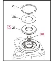
27. Shaft Seal29. Snap Ring28. Seal Support Washer
